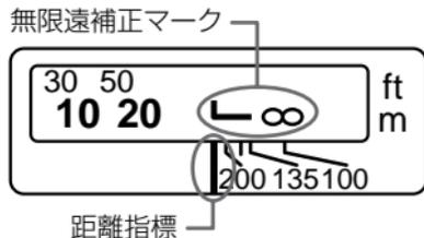
温度変化によるピント移動を補正するため、無限遠 (∞) 位置に余裕を持たせてあります。常温の無限遠位置は、Lマークの縦線と距離指標が合うところ です。
