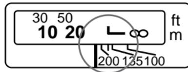
赤外指標は、白黒赤外フィルム使用時のピントを補正するためのマークです。MFでのピント調整後に、距離目盛を赤外指標の位置までずらし て撮影します。
