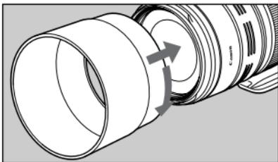
レンズフードET-83Cは、有害光線をカットするとともに、雨・雪・ほこりなどからレンズ前面を保護します。フードをフード取り付け部にあわせ、矢印の方向に回して確実に取り付けてください。収納時にはフードをレンズに逆向きにかぶせることができます。
