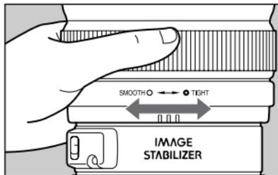
ズームリングの作動操作感（作動の重さ）は、任意に調整することができます。調整は、フォーカスリングを保持したまま、調整リングを回して行います。
