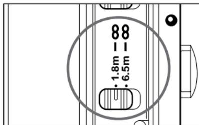
1.8m-∞または6.5m-∞の撮影距離範囲をスイッチで選べます。撮影距離に応じた設定にすることで、AF作動時間が短くなります。
