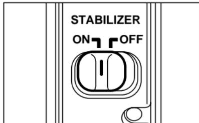
**1** 手ブレ補正スイッチをONにします。
