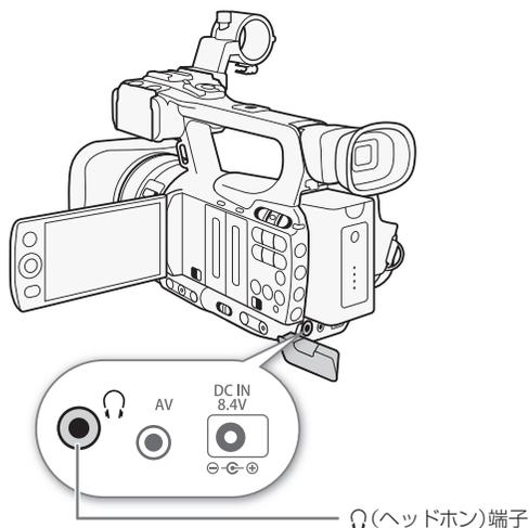
ヘッドホンをヘッドホン端子に接続して、収録される音声をモニターできます。音量はメニューまたはカスタムダイヤル ( 56) で調整します。
