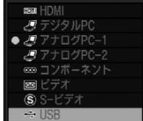
USB メモリーを接続しない状態、またハードディスクなどの電源が入っていない状態で [USB] に切り換えると、右の画面が表示されます。
