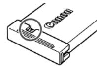
充電したバッテリーは▲が見えるように、充電前のバッテリーは▲が隠れるようにカバーを取り付けると、充電状態を見分けることができます。
