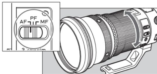
オートフォーカス (AF) で撮影するときは、フォーカスモードスイッチをAFにします。マニュアルフォーカス (MF) で撮影するときは、フォーカスモードスイッチをMFにし、フォーカスリングを回します。フォーカスリングは、フォーカスモードに関係なくいつでも動かせます。パワーフォーカス(PF)で撮影するときは、フォーカスプリセットスイッチ (P.7) がOFFの状態、フォーカスモードスイッチをPFにします。再生リングを操作することで、一定速度でピント送りが行なえます。動画撮影時のピント送りに便利です。
