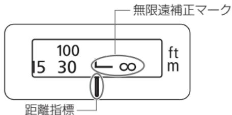
温度変化によるピント移動を補正するため、無限遠 ( $\infty$ ) 位置に余裕を持たせてあります。常温の無限遠位置は、距離目盛のLマークの縦線と距離指標が合うところです。
