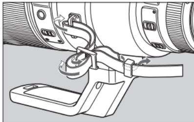
ストラップの先端を、ストラップ取り付け部に通し、さらにストラップに付いている留め具の内側を通します。ストラップを引っ掛けて、留め具の部分がゆるまないことを確認してください。
