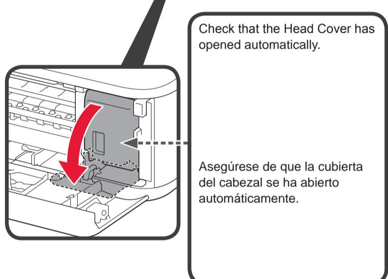
Asegúrese de que la cubierta del cabezal se ha abierto automáticamente.
