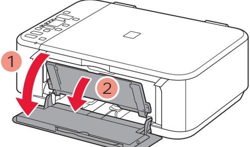
1 Abra la cubierta delantera y la bandeja de salida del papel.
