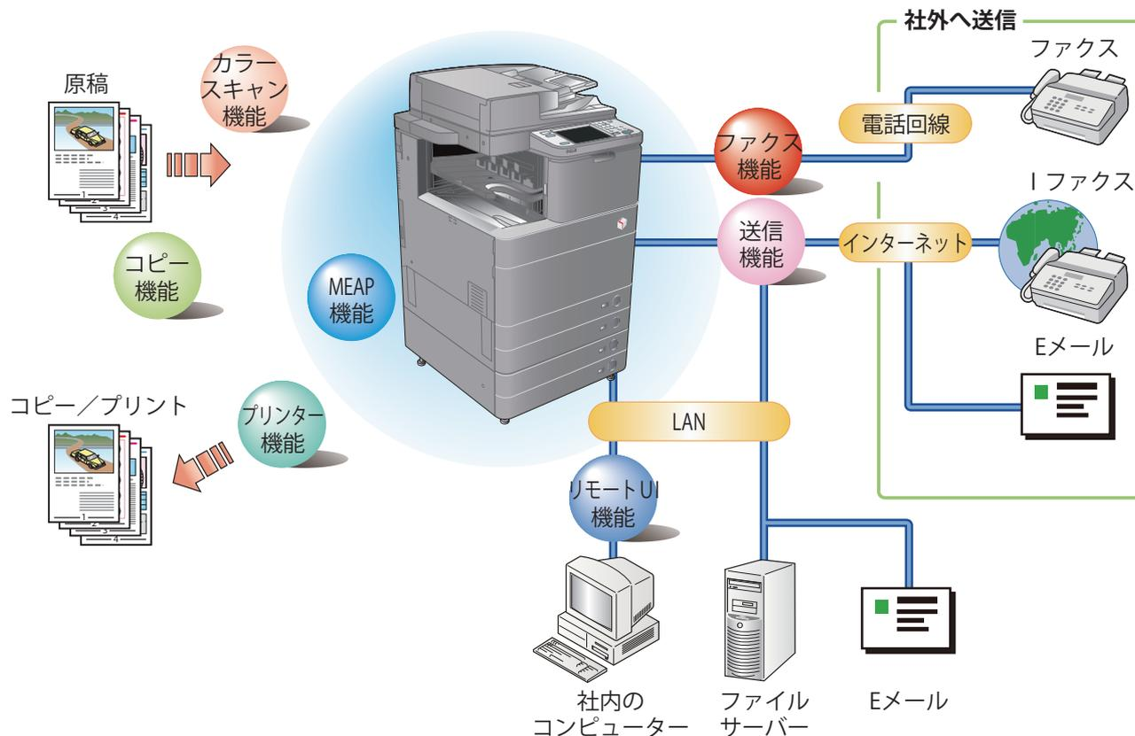
imageRUNNER ADVANCE C5255/C5255F/C5250/C5250F/C5240/C5240F/C5235/C5235F は、さまざまなドキュメントの入出力環境を効率化する機能を搭載しています。オフィスの環境やお客様のニーズに応じて機能を追加することによって、オフィスにおけるドキュメントワークを最適化することができる、新発想のカラーデジタル複合機です。
