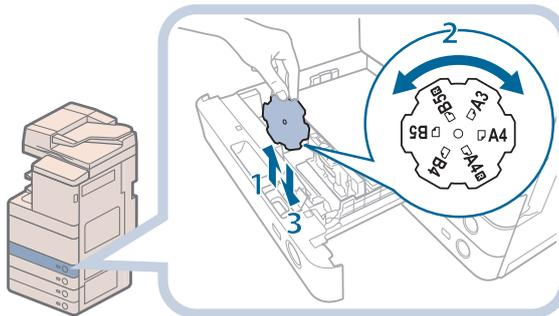
1. カセットの内カバーを開けて、ラベルを引き上げる
