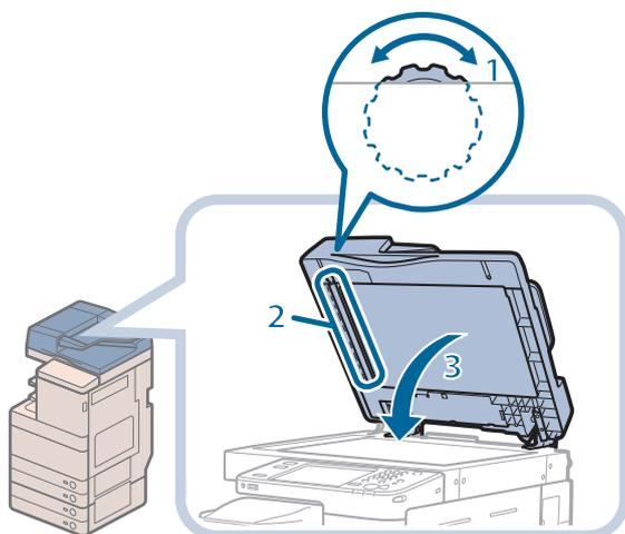
1. フィーダーカバーの内側にあるフィードダイヤルを回しながら、樹脂ローラーを回転させる
