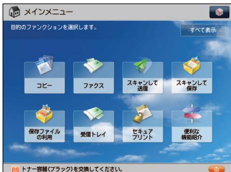
ブラックトナー、またはすべてのトナーがなくなり、プリントできない状態になると、タッチパネルディスプレイにトナー容器の交換方法が表示されます。次の手順に従ってトナー容器を交換してください。[閉じる] を押したときは、トナーをすぐに交換しなくても、モードの設定、原稿の読み込みなどの操作を続けることができます。
