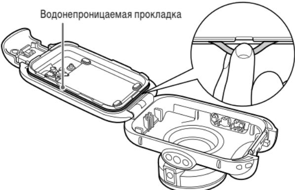
**4 Нанесите силиконовую смазку на водонепроницаемую прокладку.**
