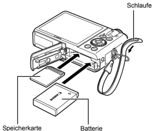
Wenn Sie bei angebrachter Schlaufe die Kamera in das wasserdichte Gehäuse einlegen, kann die Schlaufe im wasserdichten Gehäuse eingeklemmt werden und zu Undichtigkeiten führen.
