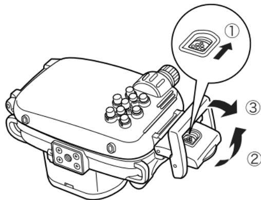
Aplique una fina capa de grasa a toda la junta antes de utilizar la funda impermeable a fin de evitar la abrasión y el deterioro.
