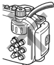
ウォーターストローフケースに、カメラ用のストラップを使用しないでください。
