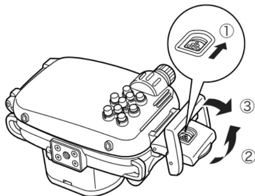
Tragen Sie eine dünne Schicht Silikon-Paste auf den gesamten Dichtungsring auf, bevor Sie das wasserdichte Gehäuse verwenden, um Verschleiß und Schäden zu vermeiden.
