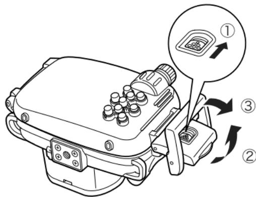
Pour éviter l'usure du joint d'étanchéité, enduisez toute la surface du joint d'une fine couche de graisse.
