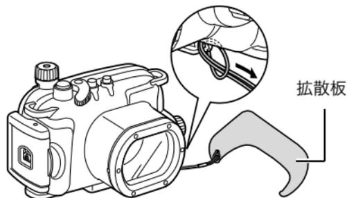
**2** 拡散板の端を、溝に差し込んで取り付けます。
