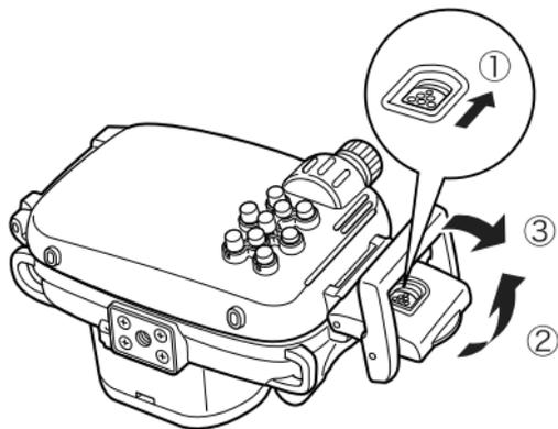
使用防水套之前，请在整个封条上涂一层薄薄的润滑脂，以防擦伤和损坏。
