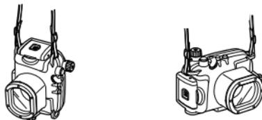
Quando trasportate la fotocamera in spiaggia, utilizzate la cinghia da collo. Prima di utilizzare la Custodia in acqua, rimuovete la cinghia da collo e montate la cinghietta da polso. Vi è il rischio che la cinghia da collo si attorcigli causando strangolamento o altre situazioni pericolose.
