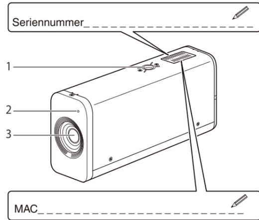
1. Montageschraubenlöcher (eine Montageschraube (1/4-20-UNC), die kürzer als 5,5 mm ist, passt in das Schraubenloch)
