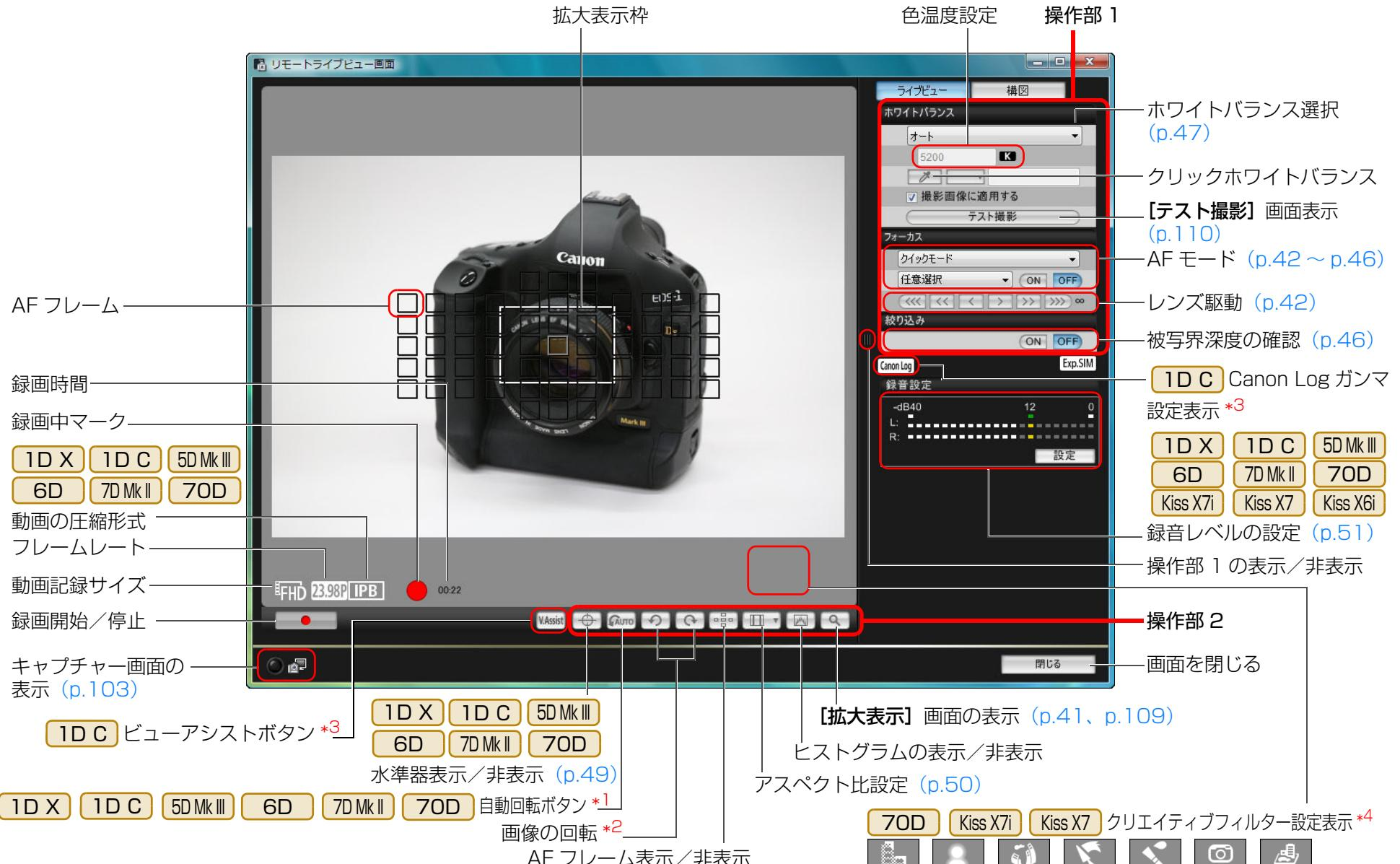
\*1 自動回転の設定時に、カメラが縦位置ということが検知されると、リモートライブビュー画面もカメラの回転方向に合わせて自動的に回転表示されます。
