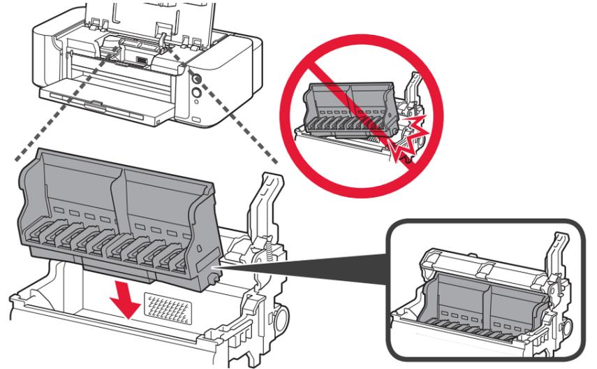
プリントヘッドを本製品に取り付ける場合には、プリントヘッドホルダーの周囲にぶつけることなく、注意してセットしてください。安全上問題はありませんが、まれに、プリントヘッドの損傷によるとみられるプリントヘッド部分の発熱・発煙事例も報告されています。
