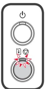
エラーランプが点滅したときは、プリントヘッドおよびインクタンクが正しく取り付けられているか確認してください。
