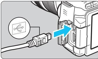
**2** 使用随附的接口电缆将相机连接到计算机。
