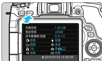
如果在相机处于拍摄就绪状态时按 <INFO.>按钮，会依次显示 [ 显示相机设置 ]、[ 电子水准仪 ] (第70页) 和 [ 显示拍摄功能 ] (第363页) 屏幕。
