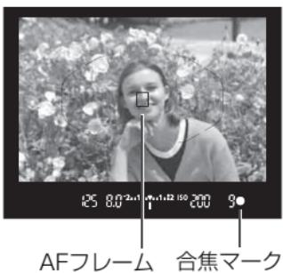
止まっている被写体の撮影に適しています。シャッターボタンを半押しすると1回だけピント合わせを行います。
