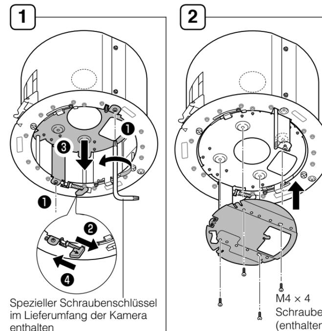
Spezieller Schraubenschlüssel im Lieferumfang der Kamera enthalten
