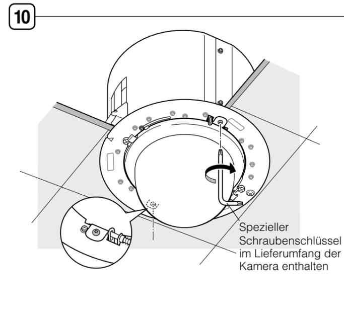
Spezieller Schraubenschlüssel im Lieferumfang der Kamera enthalten
