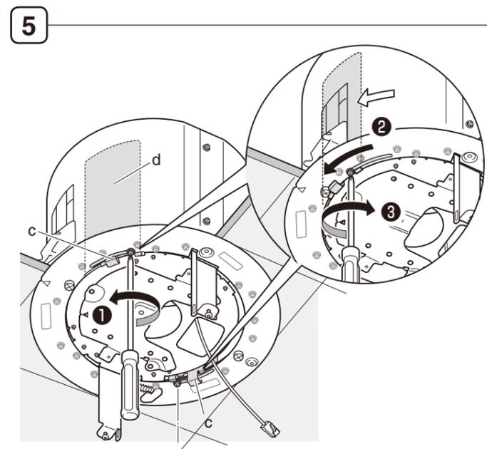
c. Manopola di apertura e chiusura dell'otturatore
