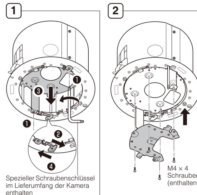
Spezieller Schraubenschlüssel im Lieferumfang der Kamera enthalten
