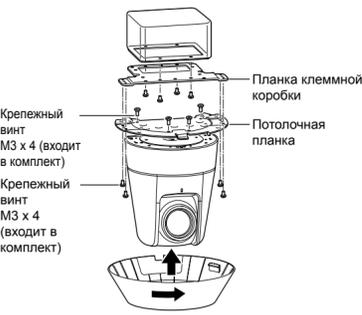
Для крепления камеры на клеммной коробке используйте планку клеммной коробки (входит в комплект крышки для потолочного монтажа (продается отдельно)).
