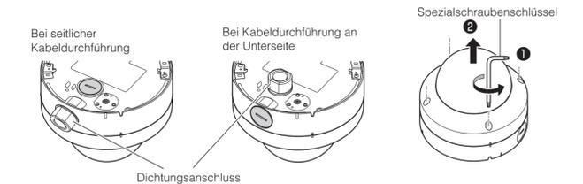
**LAN-Kabel durch die wasserdichte Dichtung führen**
