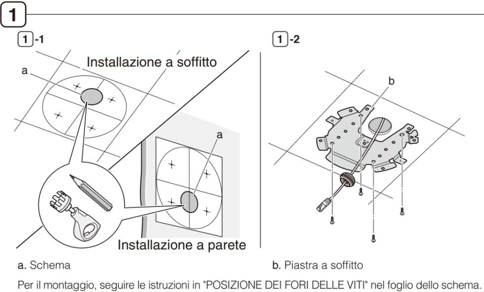
Per il montaggio, seguire le istruzioni in "POSIZIONE DEI FORI DELLE VITI" nel foglio dello schema.
