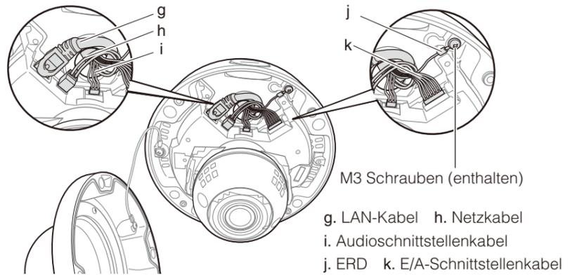
Verbinden Sie alle Kabel mit dem Anschluss an der Kameraseite.
