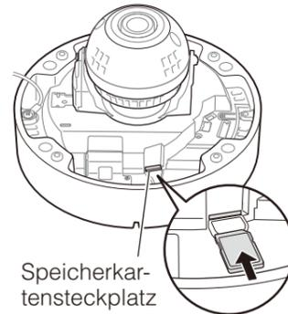
Entfernen Sie das Kuppelgehäuse und stecken Sie die Speicherkarte in den Speicherkartensteckplatz. Um die Speicherkarte zu entfernen, drücken Sie die Speicherkarte so weit hinein, bis sie leicht ausgeworfen wird und Sie sie entnehmen können.
