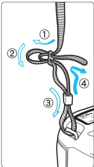
ストラップの先端をストラップ取り付け部の下から通し、さらにストラップに付いている留め具の内側を通します。留め具の部分のたるみを取り、引っぱっても留め具の部分がゆるまないことを確認してください。
