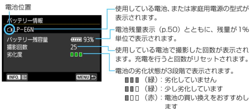
● キヤノン純正のバッテリーパック LP-E6N/LP-E6の使用をおすすめします。純正品以外の電池を使用すると、カメラ本来の性能を発揮できない恐れや、故障の原因になることがあります。
