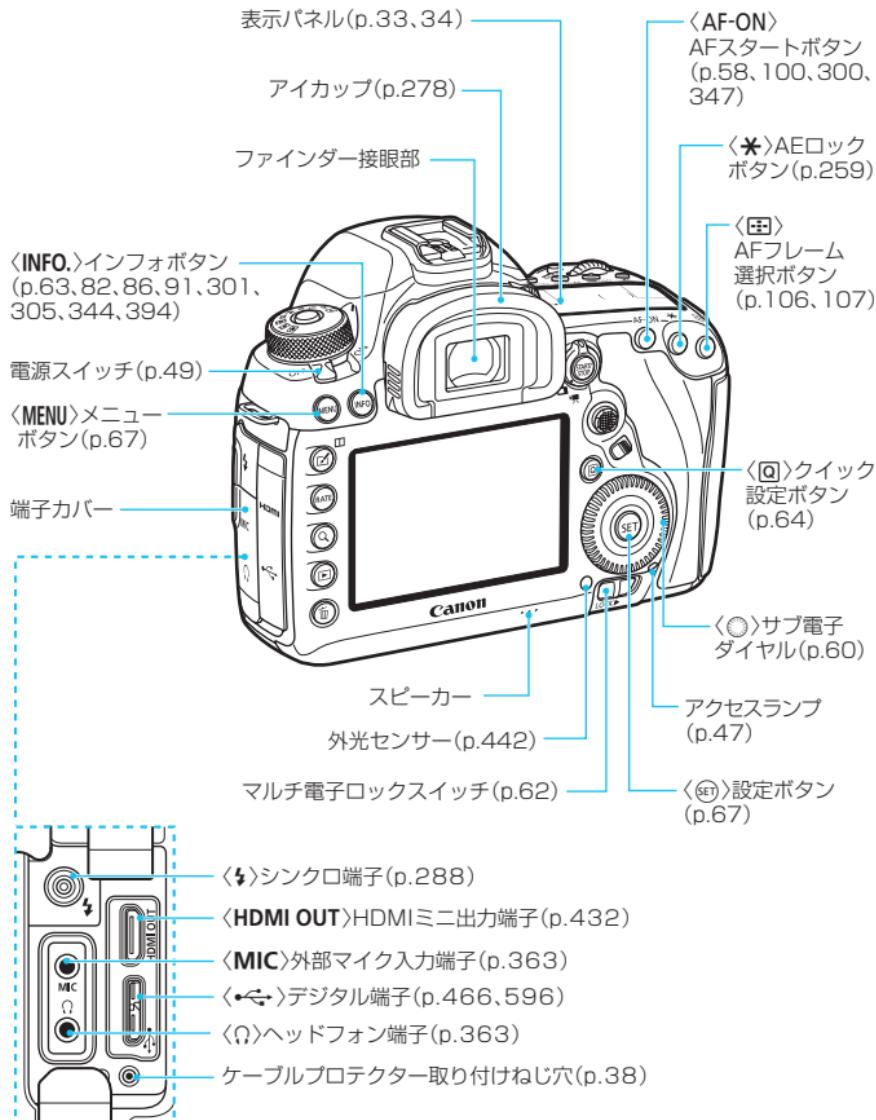
デジタル端子にインターフェースケーブルを接続するときは、付属のケーブルプロテクターを使用してください (p.38)。
