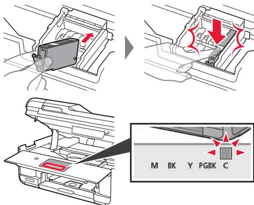
Si no se muestra el color en pantalla a pesar de haber instalado el depósito de tinta, es posible que el color del depósito de tinta no sea correcto o que haya instalado un depósito de tinta, por ejemplo, con un número de modelo distinto que no sea compatible con esta impresora. Instale un depósito de tinta para color correcto o utilice el depósito de tinta proporcionado para su instalación.
