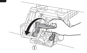
3 画面の指示に従ってプリントヘッド固定カバー②を開き、[OK] をタップします。キャリッジの電極部(A) には触らないでください。
