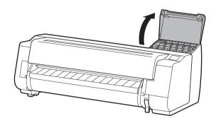
取り付ける色のインクタンク固定レバーを解除します。 持ち手部(A)を(B)の位置にあるボタンを押しながら手前に起こ してください。
