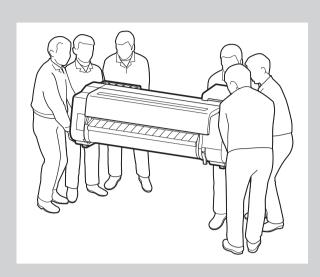
・プリンター本体を立てるときは、操作パネルのある側を上にして、傷防止のために下にダンボールなどを敷いてください。また、プリンターの角で荷重を受けるようにしてください。他の部分に負荷をかけると、プリンターを破損する可能性があります。
