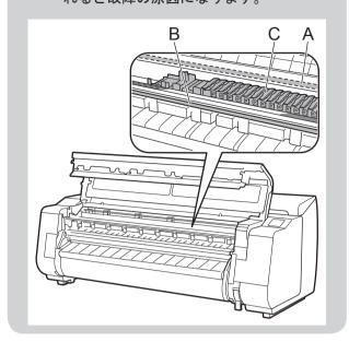
調整用の用紙の印刷面を上にし縦向きで、プラテン(A)と用紙押 さえ(B)の間に挿しこみます。必要な用紙は1枚だけです。
