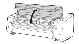
■ ベルトストッパー(A)を上に引き抜き、取り外します。
