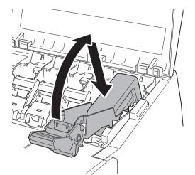
■ インクタンク固定レバーの持ち手部を しっかりと奥に押し込みます。
