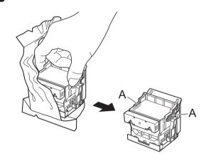
オレンジ色の保護キャップ(A、B)を取り外します。保護キャップ(B)は、つまみ部(C)を持って取り外してください。
