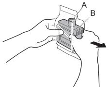
インクタンクをホルダーに取り付けます。 インク供給部を下側、端子部を奥側の向 きで取り付けてください。
