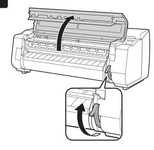
・リニアスケール (A)、キャリッジシャフト (B)、インクチューブスタビライ ザー (C) には触れないでください。触 れると故障の原因になります。
