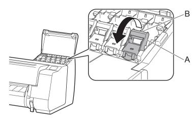
インクタンク固定レバーを引き出します。
