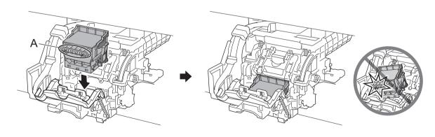
┃プリントヘッド固定カバー③を前側に倒 ┃して、プリントヘッドをロックします。
