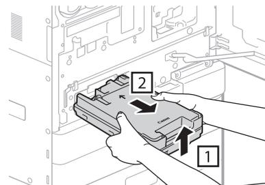
使用済みのメンテナンスカートリッジは重くなっています。必ず、しっかり持って水平に保ちながら取り出してください。インクを含んだメンテナンスカートリッジを落としたり傾けたまま放置すると、インクが漏れて周辺が汚れる場合があります。
