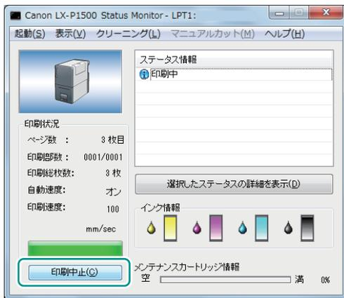
印刷を停止すると、用紙をカット位置まで移動させてカットします。
