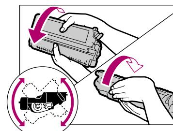
**7** Poser la cartouche sur une surface plate et horizontale. Saisir le ruban d'étanchéité et l'extraire directement de la cartouche. Ne pas tirer sur le ruban de biais. S'il se casse avant d'être complètement extrait, la cartouche ne peut pas être utilisée. Le ruban d'étanchéité mesure environ 50 cm de long. Veiller à l'extraire complètement de la cartouche.
