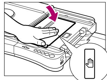
**10** Ramener le rouleau d'impression en position centrale. Coloque de nuevo la platina en la posición central.
