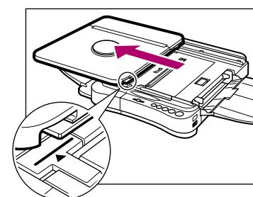
**3** Appuyer sur le bouton d'ouverture du capot supérieur et soulever celui-ci pour le mettre à la verticale.
