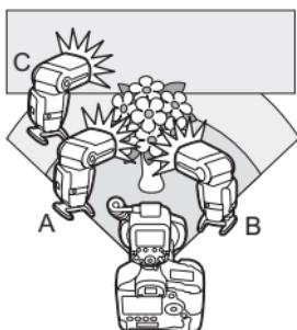
Lorsque C.Fn-15 est réglé sur 1 (p. 63), la prise de vue avec plusieurs flashes peut être effectuée non seulement avec le flash asservi C, mais également avec les flashes asservis A et B. Pour un aperçu du contrôle des flashes, voir « Gestion des groupes asservis » à la page 46.
