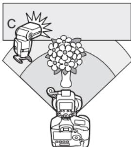
Cette section décrit la prise de vue avec plusieurs flashes où le flash asservi C est ajouté aux tubes de flash A et B.
