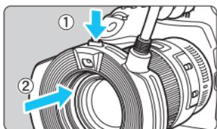
**Fixez le flash sur l'avant de l'objectif tout en maintenant enfoncé le bouton de déverrouillage.**
