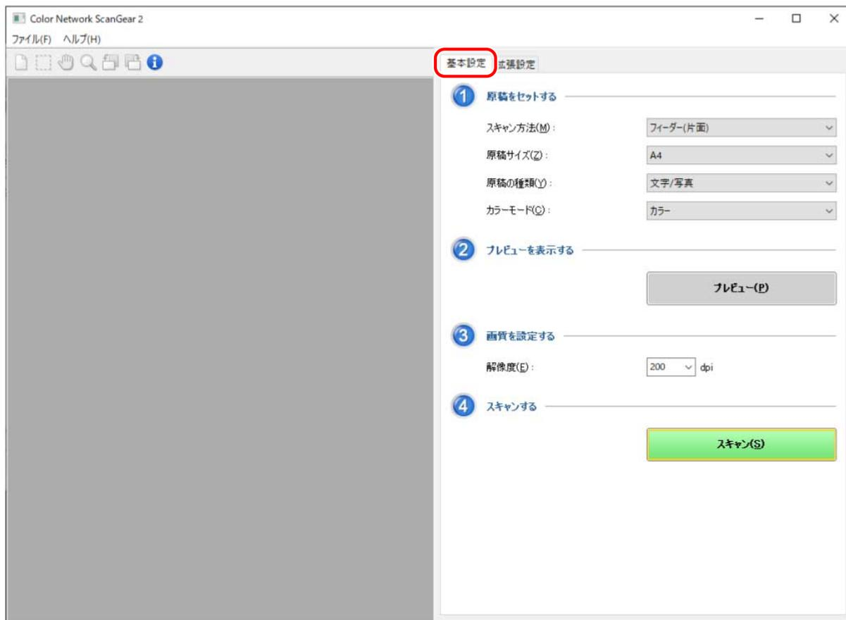
**4** [スキャン方法] で原稿をセットした場所を選択 → [原稿サイズ] でスキャンする原稿のサイズを選択
