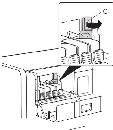
4. 固定レバー（C）を矢印の方向に動かします。
