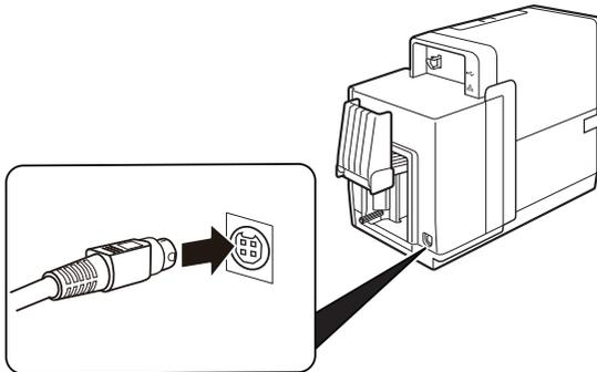
1. 電源コードのコネクタを AC アダプターに差し込みます。
