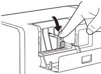
1. インク供給口を下に向けて、インクタンクをプリンターに差し込みます。
