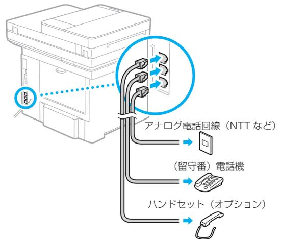
必ず回線を確認してから接続してください。ビジネスホンなどを接続している専用回線に接続すると、故障の原因になります。
