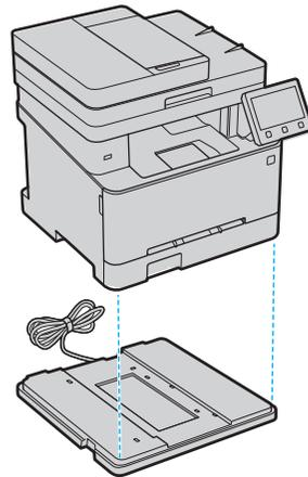
3. 本機の電源コードを接続するときに、環境ヒーターのアース線と電源コードも接続する
