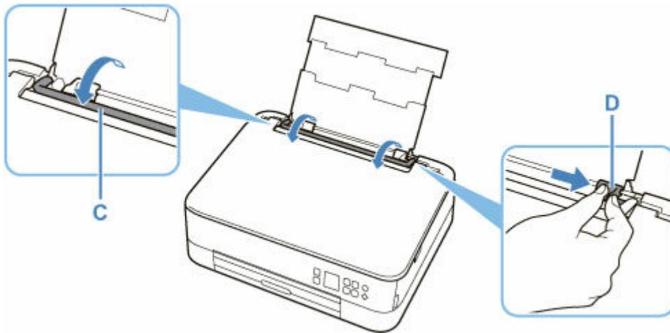
5. 印刷したい面を表にして、用紙を縦にセットする
