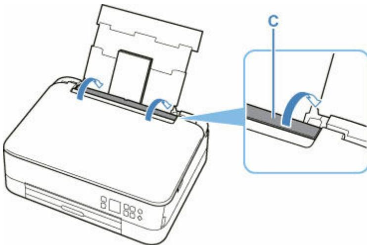
給紙口カバーを閉じると、液晶モニターに後トレイの用紙の設定を確認する画面が表示されます。
