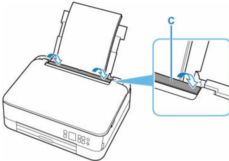
給紙口カバーを閉じると、液晶モニターに後トレイの用紙の設定を確認する画面が表示されます。
