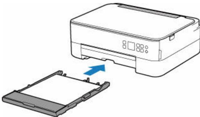
用紙のサイズが自動で検知され、プリンターに設定されます。
