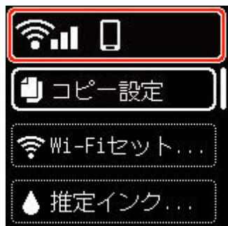
液晶モニターに
