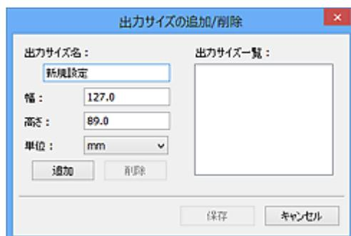
[出力サイズの追加/削除] ダイアログボックスでは、複数の出力サイズを設定し、一度に保存することができます。保存した出力サイズは、[出力サイズを選択する] の選択項目に登録され、既存の項目と同様に選択できます。
