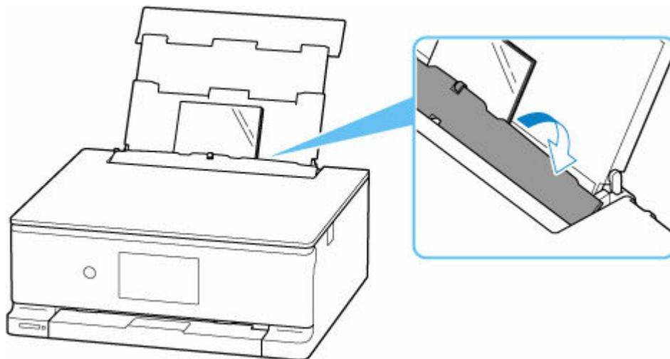
給紙口カバーを閉じると、タッチスクリーンに後トレイの用紙の設定を確認する画面が表示されます。
