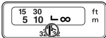
赤外指標は、白黒赤外フィルム使用時のピントを補正するためのマークです。MFでのピント調整後に、距離目盛を赤外指標の位置までずらして撮影します。
