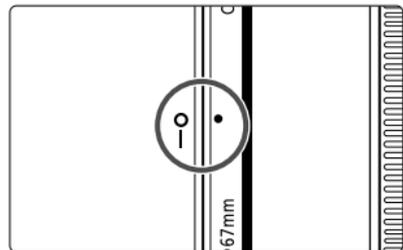
フードの赤い取り付け位置マークとレンズ先端の赤指標をあわせ、レンズの赤指標とフードの停止位置マークが合うまで、フードを矢印の方向に回して確実に取り付けてください。
