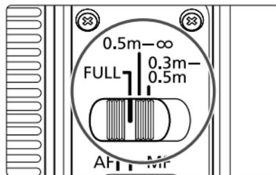
FULL（0.3m-∞）、0.3m-0.5mまたは0.5m-∞の撮影距離範囲をスイッチで選べます。撮影距離に応じた設定にすることで、AF作動時間が短くなります。
