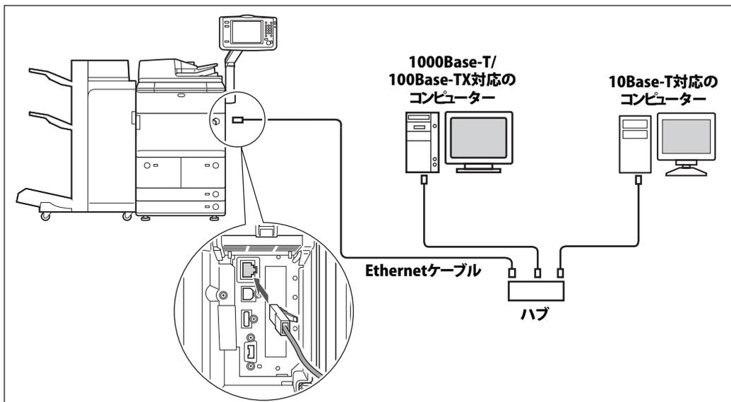
**警告** ネットワークケーブルを接続するときは、必ず本体右側面にある主電源スイッチを切り、電源プラグを電源コンセントから抜いてください。(→「第1章 お使いになる前に」) 感電の原因となることがあります。
