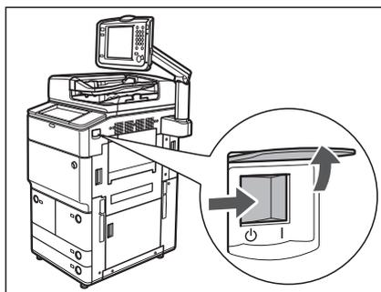
主電源スイッチを操作するときは、主電源スイッチのカバーを開いてください。
