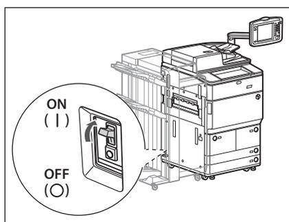
**4** 主電源スイッチを「|」側へ倒します。
