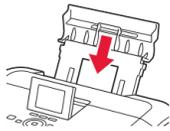
Utilisez **uniquement** le **réceptacle arrière** pour le chargement du papier photo. Lorsque vous utilisez ce type de papier, il vous faut modifier les paramètres de la machine relatifs au type et au format de support. Pour plus d'informations, reportez-vous au **Manuel en ligne**, qui sera installé ultérieurement.
