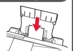
Utilisez uniquement le réceptacle arrière pour le chargement du papier photo. Lorsque vous utilisez ce type de papier, il vous faut modifier les paramètres de la machine relatifs au type et au format de support. Pour plus d'informations, reportez-vous au Manuel en ligne, qui sera installé ultérieurement.
