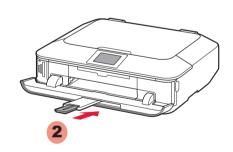
2 2 - 8 ~ 3 - 6 を参照し、用紙をカセットにセットする 用紙ガイドはセットする用紙のサイズに合わせる
