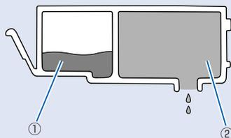
まず①がなくなると、インクランプがゆっくり点滅し、インクが少なくなったことをお知らせします。次に②がなくなると、インクランプの点滅がはやくなり、新しいインクタンクへの交換をお知らせします。
