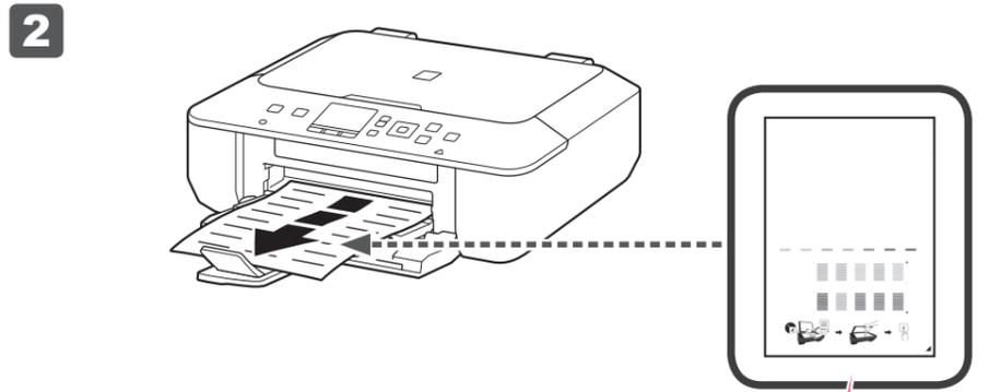
**2** パターンが印刷されたら、原稿台にパターンをセットする
