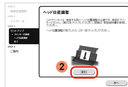
[ヘッド位置調整] 画面が表示されたら、付属の専用紙（マットフォトペーパー MP-101）を2枚、後トレイにセットし、[実行] をクリックします。用紙の角が斜めになっている部分を右上にして、縦向きにセットしてください。
