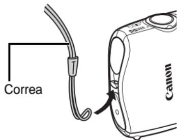
La correa de la cámara puede quedar pillada en la junta hermética al abrir o cerrar la funda impermeable si no quita la correa antes de colocar la cámara en la funda impermeable. Puede causar filtraciones.
