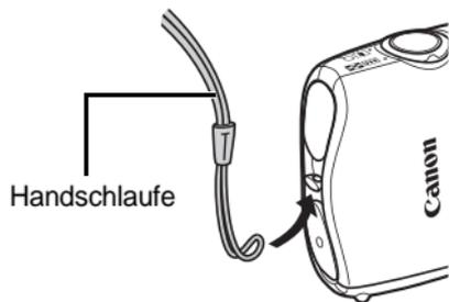
Wenn Sie die Kamera in das wasserdichte Gehäuse einsetzen, ohne die Handschlaufe zu entfernen, kann sich die Handschlaufe beim Öffnen oder Schließen des wasserdichten Gehäuses in der Dichtung verfangen und Lecks verursachen.
