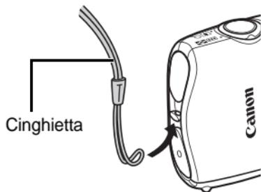
Se si inserisce la fotocamera nella Custodia Impermeabile senza prima rimuovere la cinghietta, essa potrebbe impigliarsi nella guarnizione impermeabile quando si apre o si chiude la Custodia Impermeabile. Questo potrebbe causare infiltrazioni d'acqua.
