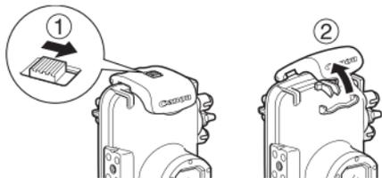
使用防水套之前，请在整个封条上涂一层薄薄的润滑脂，以防擦伤和损坏。
