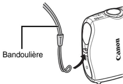
Si elle n'est pas retirée, la bandoulière de l'appareil photo peut se coincer dans le joint d'étanchéité lors de l'ouverture ou de la fermeture du boîtier étanche et entraîner des infiltrations d'eau.
