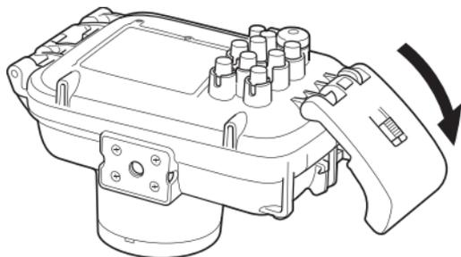
**7** Tournez la molette de sélection des modes dans le sens de la flèche pour utiliser la molette de sélection des modes de l'appareil.
