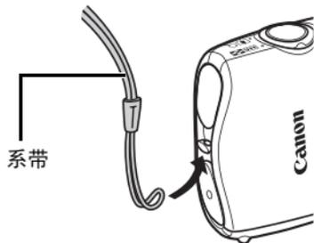
如果在将相机装入防水套时不先取下系带，打开或关闭防水套时，系带可能会被夹在防水封条中，从而导致漏水。
