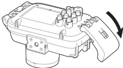
7 按照箭头方向转动模式开关来操作相机模式开关。
