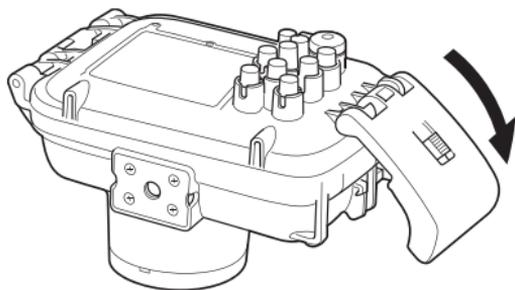
**7** Spostate il selettore di modalità in direzione della freccia per attivare il selettore di modalità della fotocamera.
