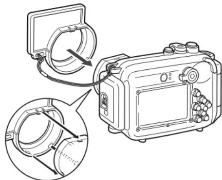
**Achten Sie beim Schließen der Verriegelung des wasserdichten Gehäuses darauf, dass die Schnur der Streuscheibe nicht eingeklemmt wird.**
