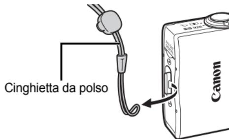
La cinghietta da polso della fotocamera digitale potrebbe impigliarsi nella guarnizione impermeabile quando si apre o si chiude la Custodia Impermeabile. Se non viene staccata, potrebbe causare infiltrazioni d'acqua.
