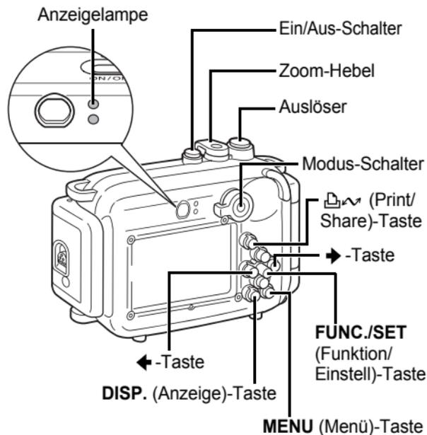
**7 Betätigen Sie den Ein/Aus-Schalter, um das Gerät einzuschalten.**
