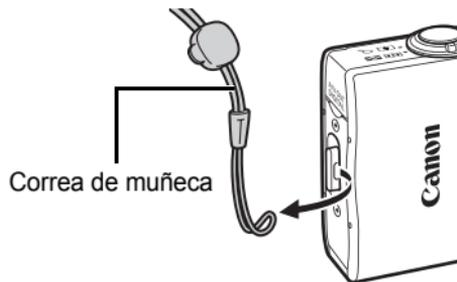
La correa de muñeca de la cámara puede quedar pillada en la junta hermética al abrir o cerrar la funda impermeable y causar la infiltración de agua si no se quita.
