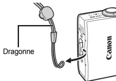
Si elle n'est pas retirée, la dragonne de l'appareil photo peut se coincer dans le joint d'étanchéité lors de l'ouverture ou de la fermeture du boîtier étanche et entraîner des infiltrations d'eau.
