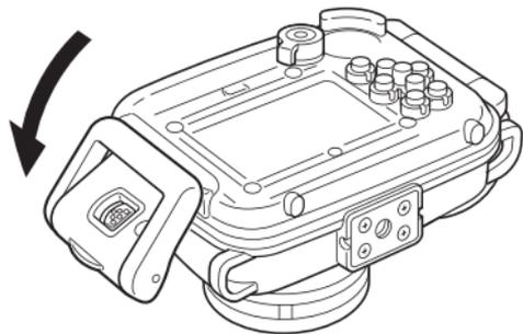
8 モードスイッチを矢印のように回し、カメラのモードスイッチとかみ合わせます。
