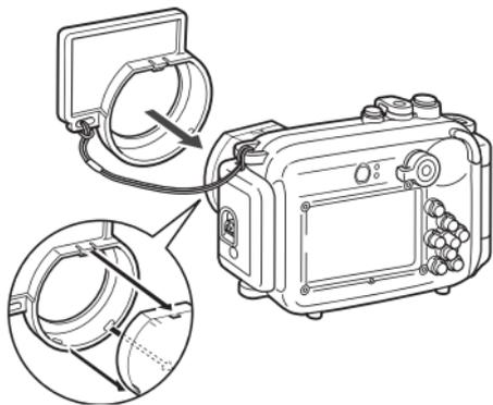
关闭防水套的扣环时，请确定不要夹住扩散闪光板的细绳。
