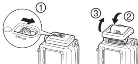
Prima di usare la Custodia Impermeabile, applicate uno strato sottile di grasso su tutta la guarnizione in modo da prevenire rischi di abrasioni e deterioramento.
