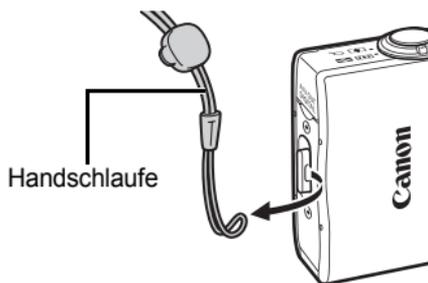
Die Handschlaufe der Kamera kann sich beim Öffnen oder Schließen des wasserdichten Gehäuses in der Dichtung verfangen und Lecks verursachen, wenn sie nicht entfernt wird.
