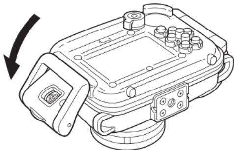
**8 Drehen Sie den Modus-Schalter in Pfeilrichtung, um den Modus-Schalter der Kamera zu betätigen.**
