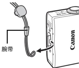
如果不取下相机的腕带，防水套打开或关闭时，腕带可能会被夹在防水封条中，而导致漏水。
