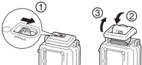
使用防水套之前，请在整个封条上涂一层薄薄的润滑脂，以防擦伤和损坏。
