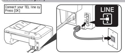
Conecte el equipo a una clavija de línea telefónica con el cable de línea telefónica suministrado y, a continuación, pulse el botón OK.
