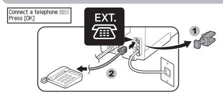
Si desea conectar un teléfono o un contestador, retire la tapa, conecte un teléfono o un contestador automático con un cable de línea telefónica y pulse el botón OK.
