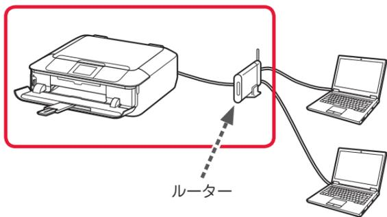
LAN ケーブル (Ethernet ケーブル) を使って接続します。
