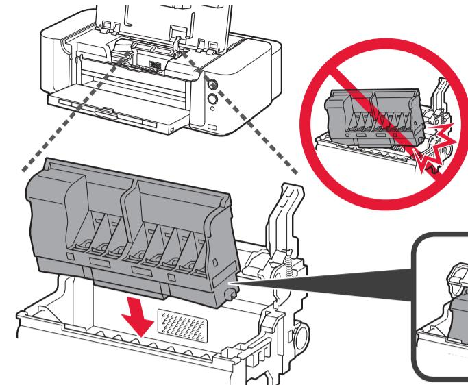
プリントヘッドを本製品に取り付ける場合には、プリントヘッドホルダーの周囲にぶつけることなく、注意してセットしてください。安全上問題はありませんが、まれに、プリントヘッドの損傷によるとみられるプリントヘッド部分の発熱・発煙事例も報告されています。
