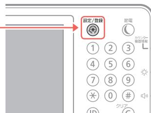
② タッチパネルディスプレイで[調整/メンテナンス] ▶ [画質調整] ▶ [自動階調補正]を押す
