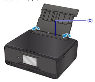
3. 用紙ガイドを広げ、<u>封筒の印刷したい面を表に</u>して、後トレイの中央にセットする 一度に 10 枚までセットできます。
