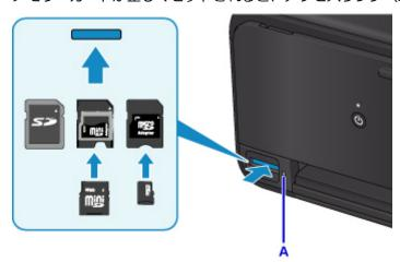
以下のメモリーカードはカードアダプターに取り付けてから、カードスロットにセットしてください。
