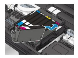
8. インクタンク上面を「カチッ」と音がするまでしっかり押して、インクタンクを固定する 取り付けたら、インクランプが点灯したことを確認してください。
