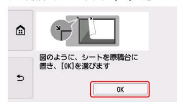
手書き文字を書き込んだ面を下にして、図のようにディスクレーベル手書きナビシートの左下隅の**ピ**マークを原稿位置合わせマーク(┪)に合わせ、原稿台カバーを閉じます。
