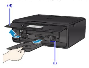
11. 印刷面を上にして、プリンタブルディスクをディスクトレイにセットする
