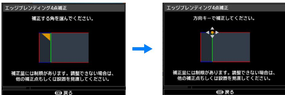
**4 投写画面を見ながら基準となるプロジェクターのマーカーと、調整中のプロジェクターのマーカーができるだけ重なるように調整します。**
