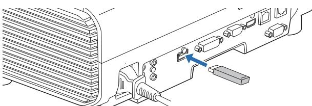
USB メモリは、本機の USB 端子に直接接続するか、USB ケーブルで USB マルチカードリーダを接続します。USB ハブを介して接続した場合は、USB メモリを認識しません。
