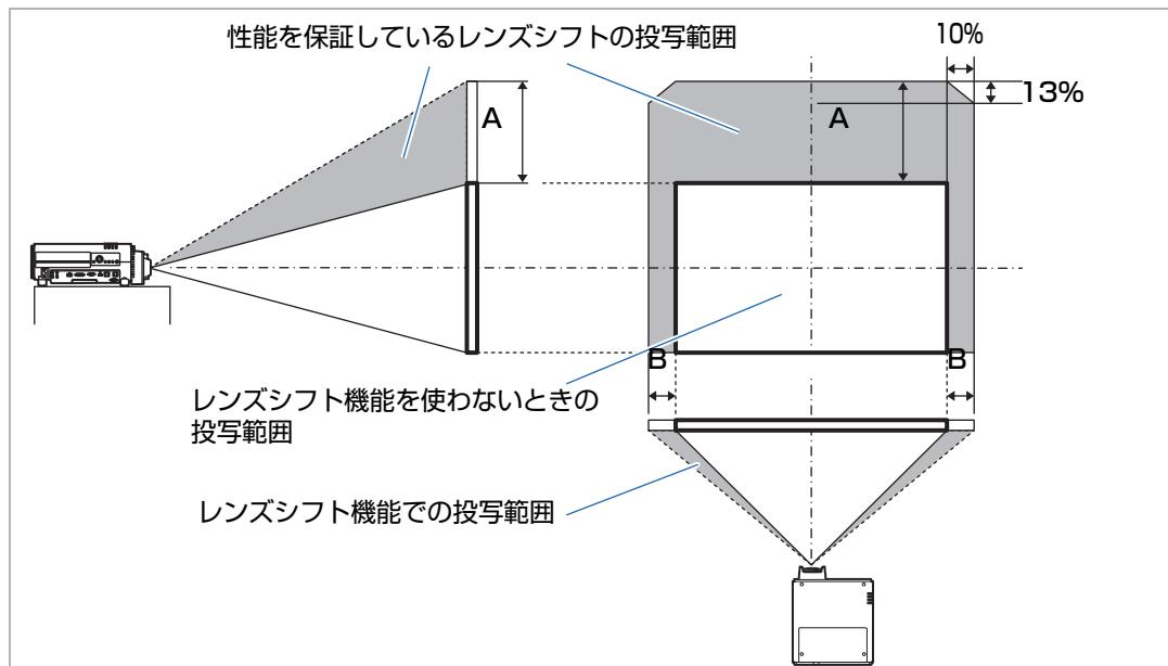
レンズシフトによる上方向（A）と左右方向（B）の最大移動量（参考値） [cm]
