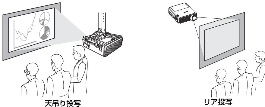
天吊りには、専用の天吊り金具を使用します。天吊り金具については、[184ページ](#)の「別売品」を参照してください。詳しくは、天吊り金具に付属の組立・設置説明書を参照してください。
